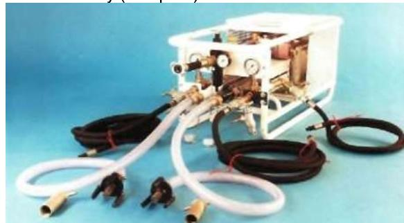
Важно: время отверждения зависит от температуры продукта и грунта (земельного массива). Перед применением хранить компоненты при температуре не ниже +5°C. Для достижения оптимального смешивания компонентов в процессе инъектирования настоятельно рекомендуется использование
